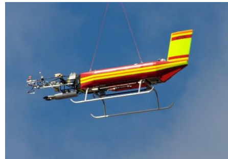
Abbildung 1: Die Hubschraubergetragene Plattform ACTOS.
