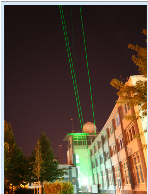
Fig. / Abb. 4: Laser beams transmitted at IFT by Polly (2-channel lidar), two Polly XT (6-channel lidars), and the EARLINET lidar (9-channel lidar). / Laserstrahlen über dem IFT von Polly (2-Kanal-Lidar), zwei Polly XT (6-Kanal-Lidar) und dem EARLINET-Lidar (9-Kanal-Lidar).
