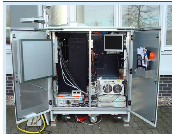
Fig. / Abb. 13: Mini Raman lidar Polly XT in an air-conditioned cabinet. / Mini-Ramanlidar Polly XT im klimatisierten Gehäuse.
