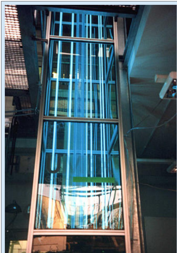
Fig. / Abb. 11: The IfT laminar flow tube reactor (IfT-LFT). / Der laminare Rohrreaktor des IfT.
