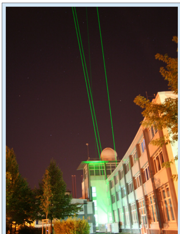
Fig. / Abb. 3: Laser beams transmitted at IFT by Polly (2-channel lidar), two Polly XT (6-channel lidars), and the EARLINET lidar (9-channel lidar). / Laserstrahlen über dem IFT von Polly (2-Kanal-Lidar), zwei Polly XT (6-Kanal-Lidar) und dem EARLINET-Lidar (9-Kanal-Lidar).
