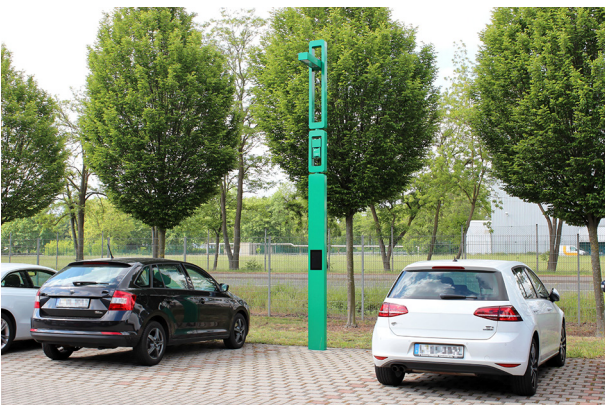
Fig. / Abb. 9: The FDS15 is a measuring device that comes in a small box the length of a tetra-pack and can be attached to light poles, among other things. / Das FDS15 ist ein Messgerät, das in einem kleinen Kästchen von der Länge eines Tetra-Packs steckt und u.a. an Laternenmasten angebracht werden kann. (Photo: Dr. Födisch Umweltmesstechnik AG)
