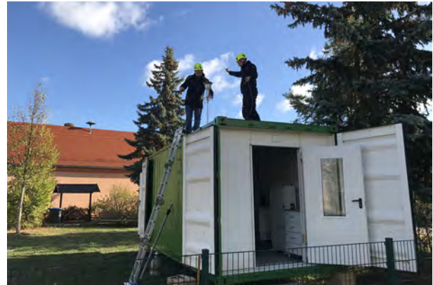
Fig. / Abb. 7: TROPOS is investigating the influence of wood heating on air quality in Melpitz near Torgau by comparing measurements from a measuring container in the village centre with those from the station on the outskirts of the village. / Den Einfluss von Holzheizungen auf die Luftqualität untersucht TROPOS in Melpitz bei Torgau und vergleicht dazu Messungen aus einem Messcontainer im Ortskern mit denen aus der Station am Rande des Orts. (Photo: Gerald Spindler / TROPOS)
