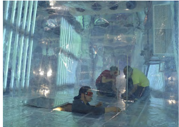
Fig. / Abb. 15: Start of the second aerosol chamber for parallel measurements with the new double chamber ACD-C in the laboratory building for atmospheric chemistry. / Inbetriebnahme der zweiten Aerosolkammer für Parallelmessungen mit der neuen Doppelkammer ACD-C im Laborgebäude für Chemie der Atmosphäre. (Photo: Tilo Arnhold / TROPOS)
