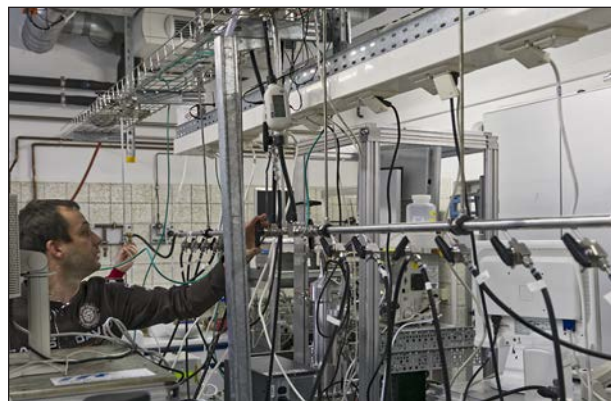
Fig. / Abb. 13: Inter comparison measurements for quality insurance with particle mobility size spectrometer in one of the TROPOS WCCAP laboratories (World Calibration Center for Aerosol Physics). / Vergleichsmessungen zur Qualitätssicherung mit Partikelgrößenpektrometern in einem der Labore des Weltkalibrierzentrums für Aerosolphysik (WCCAP) des TROPOS. (Photo: Tilo Arnhold / TROPOS)
