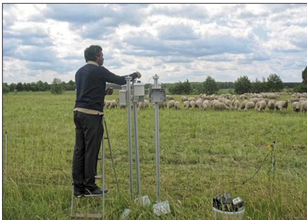
Fig. / Abb. 6: Pyranometer measurements during the Melpitz Column Experiment 2015. / Pyranometer-Messungen während der Intensivmesskampagne Melpitz-Säule 2015. (Photo: Janine Lücknerath / University of Bayreuth).
